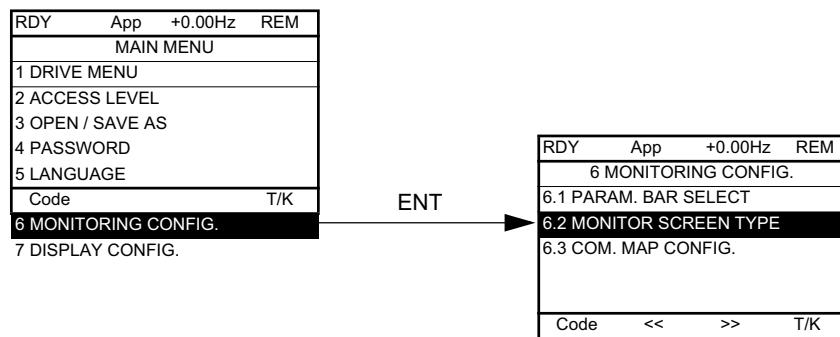
**[6.2. MONITOR SCREEN TYPE]:** Выбор параметров, отображаемых в центре дисплея и режима отображения (цифровые значения или графический вид (гистограмма)).
