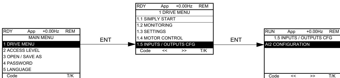
Сконфигурите AI2 в соответствии с характеристиками применяемого датчика давления (Например: 4 - 20 mA)
