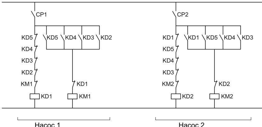
Для насосов от 3 до 5, схема повторяется, с увеличением индексов обозначений (KDx, KMx, CPx).
